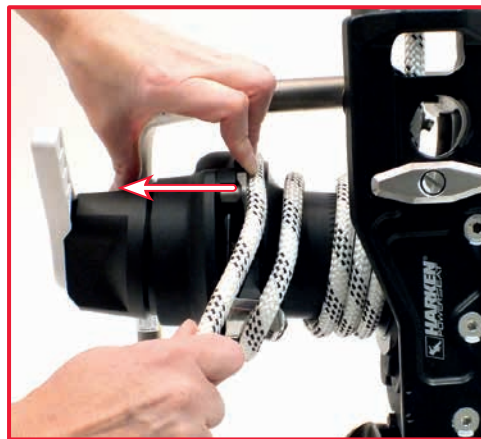
10. prevlečte lano pomedzi obe polokladky. Pre uľahčenie činnosti pozdvihnite kryt.
