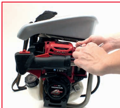
2. za pomoci imbusového kľúča č.5 odskrutkujte 4 skrutky, ktorými je sedadlo pripevnené o rám
