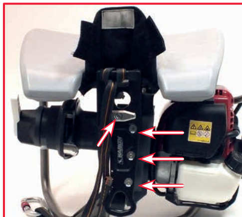
Skontrolujte všetky skrutky a overte, či sa značenie udávajúce polohu skrutiek nezmenilo, čo by mohlo viesť ku zmene ich správneho dotiahnutia. Ak zistíte odchýlky, obráťte sa na servisné stredisko HARKEN.
