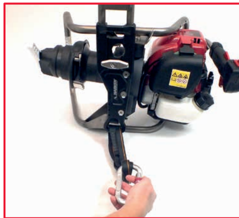
6. pripevníte pás do dolného bodu ukotvenia
