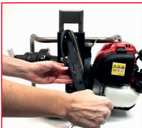
3. uvoľnite pás z horného bodu ukotvenia
