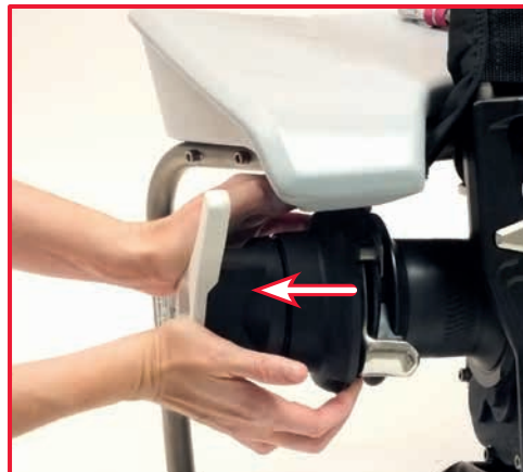
Overte pohyblivosť krytu polokladiiek.
