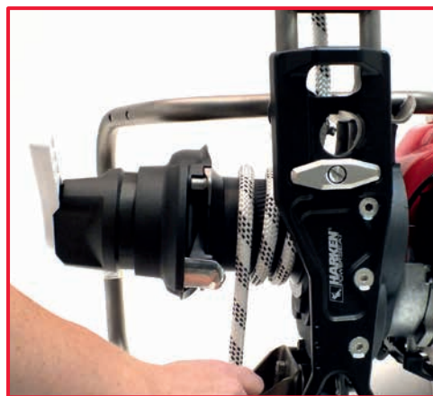
8. lano navíjajte na zvon navíjadla v smere hodinových ručičiek
