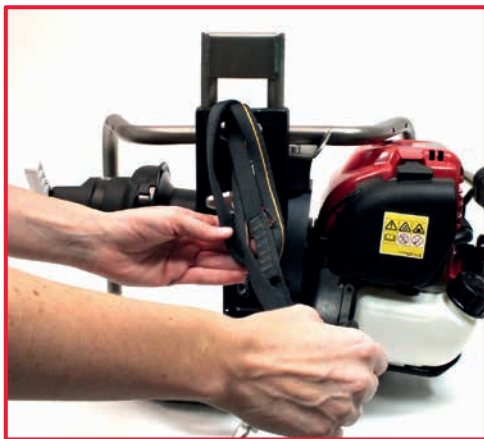
5. uvoľníte pás z horného bodu ukotvenia
