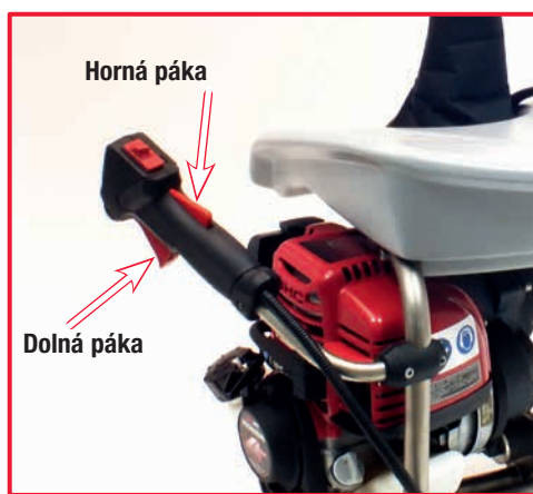
9. pre výstup uchopte celú červenú hornú páku a súčasne upravujte rýchlosť prostredníctvom spodnej červenej páky.
